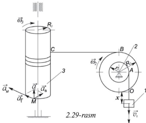
**2-masala.** 1-jismning harakat tenglamasi  $x = 5 + 8t^2$  ga ko'ra, uning vertikal o'q bo'ylab,  $s = 0,32$  m yo'lni bosib o'tgan vaqt momentida, 4-jism  $M$  nuqtasining tezligi, urinma, normal va to'la tezlanishlari topilsin. 2-, 3-, 4-jismlar radiuslari  $r_2 = 16$  sm,
