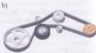
3.25-rasm. Egiluvchan bog'lanishli mexanizmlar: a) tasmalm va zanjirli uzatmalardan tashkil topgan yuritma, b) tasmalm uzatma,
