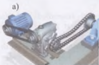
3.25-rasm. Egiluvchan bog'lanishli mexanizmlar: a) tasmalm va zanjirli uzatmalardan tashkil topgan yuritma, b) tasmalm uzatma,
