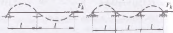
2.102 – rasm. Sterjenni ikki va uch yarim to'liqinli (sinusida) noustuvor holatalari
