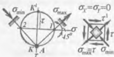
2.49-rasm. Sof siljishda bosh kuchlanishlarni aniqlash uchun Mor doirasi
