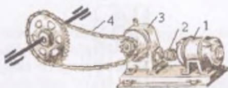
4.4-rasm. Zanjirli va bir pog'onali chervyakli uzatmalardan tashkil topgan yuritma 1 – elektrodvigatel; 2 – mufta; 3 – bir pog'onali chervyakli reduktor; 4 – zanjirli uzatma
