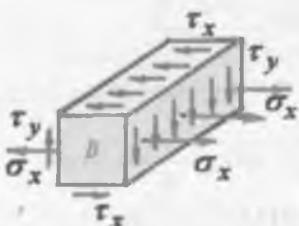
Ushbu materialdan ajratilgan kubik shaklidagi elementning old qismi - balkaning yon sirtiga ustma - ust tushadi. Bu yuza normal va urinma kuchlanishlaridan ozod, shuning uchun bu yuzacha bosh yuza, elementni vertikal yuzalari normal  $\sigma_x$  va  $\tau_y$  urinma kuchlanishlar, gorizontal
