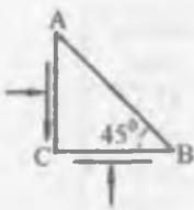
**2.6-misol.** Rasmda tasvirlangan uchburchak elementning AS va SV yoqlari bo'yicha bir xil qisuvchi normal kuchlanishlar – 50 MPa va urinma kuchlanishlar ta'sir qiladi, AV yoqqa esa yuk qo'yilmagan. AS va SV yoqlar bo'yicha urinma kuchlanishlar qiymatini hamda asosiy kuchlanishlarning qiymati va yunalishini aniqlang.
