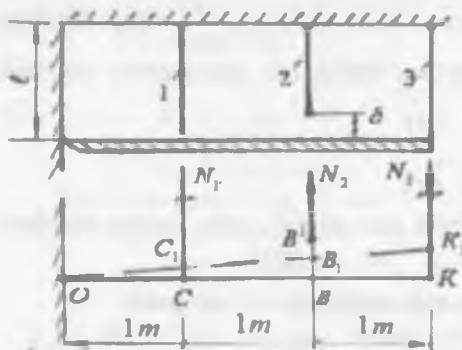
50-rasm Statik noaniq sterjenlar sistemasi va sterjenlar deformatsiyalarining o'zaro bog'lanish sxemasi
