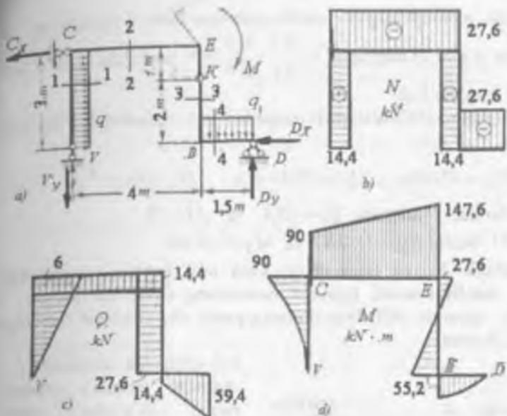
6.20 – rasm. Ramada ichki kuch faktorlarini aniqlash: a) ramani yuklanish sxemasi; b) ichki bo'ylama kuch epyurasi; v) ko'ndalang kuch epyurasi; g) eguvchi moment epyurasi
