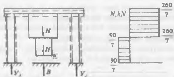
52 – rasm. Asosiy sistema va ichki kuch epyurasi
