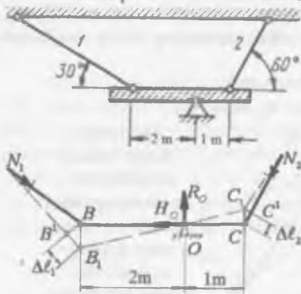
47 – rasm. Temperatura ta'siridagi statik noaniq sterjenlar sistemasi va sterjenlar deformatsiyalarining o'zaro bog'lanish sxemasi
