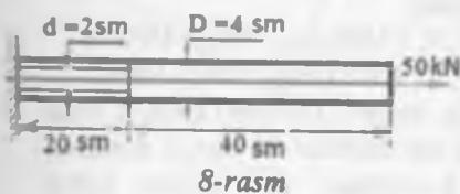
Javob: Chap uchastkada  $\sigma = -53,1 \text{ MPa}$ , o'ng uchastkada  $\sigma = -39,7 \text{ MPa}$ ;  $\Delta l = 0,132$
