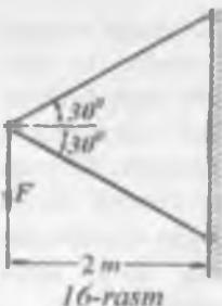
**15-misol.** 16-rasmda tasvirlangan kron-shteyn R kuchi bilan yuklangan. Ikkala sterjen po'latdan yasalgan. Ustki ster-jen ikkita shveller № 12 dan, pastkisi ikkita № 24 dan iborat. Cho'zilishga yo'l qo'yilgan kuchlanish 160 MPa, siqishga yo'l qo'yilgan kuchlanish – 100 MPa. Eng katta yo'l qo'yilgan nagruzka R ni va nagruzka qo'yilgan uzelning vertikal siljishini aniqlang. **Javob:**  $R=348 \text{ kN}$ ,  $\Delta = 2,70 \text{ mm}$
