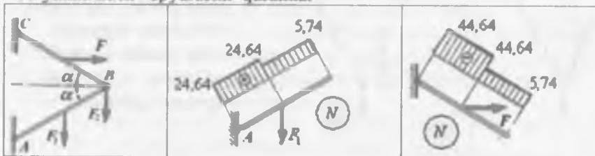
7-rasm. Sterjenlarda ichki buylama kuch epyurasi.
