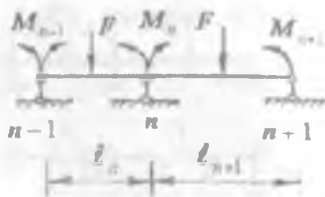
7.51-rasm. Ikki prolyotli uzluksiz balka
