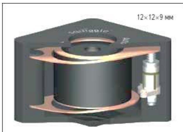
3.3.8-rasm. SQUIGGLE p'yezoyuritmasini uyali telefon fotokamerasida ishlatilishi
