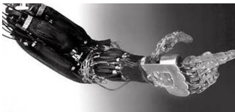
2.4.3-rasm. Oldindan dasturga kiritilmagan topshiriqlarni bajarishga moʻljallangan protez uchun ishlatiladigan manipulyator
