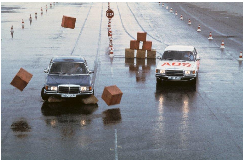
2.3.3-rasm. ABSning samaradorligini koʻrsatuvchi foto
