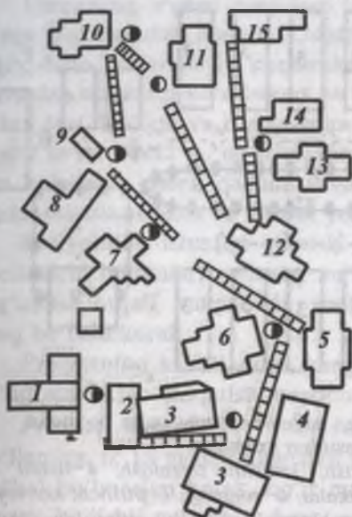
7.27—rasm. Oqim bo'yicha liniyada detallar va ishchi yo'lini qisqartirish maqsadida dastgohlarni joylashtirish. (sonlar dastgohlarning tartib raqamini bildiradi).
