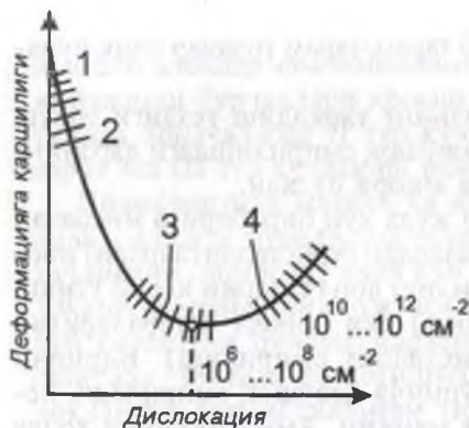
50-расм. Металлларнинг деформацияга қаршилигини тузилишдаги нуқсон зичлигига боғлиқлиги графиги.
