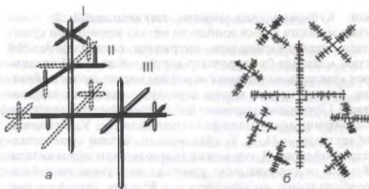
17-расм. Дендрит кристалл (а) ва унинг ўсишини тушунтирувчи чизма (б).
