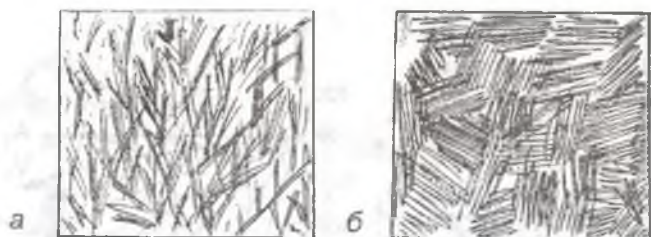
75-расм. Пластина (а) ва таёқча (рейка) (б) шаклидаги мартенситнинг микротузлиши.
