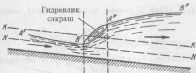
8.22-расм. Гидравлик сакраш
