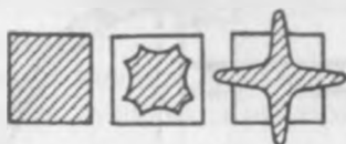
6.5-расм. Оқимча кесими шаклининг ўзгариши
