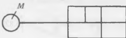
5.14-расм. Ҳалқасимон тармоқ тасвири. M — босимли сув минораси
