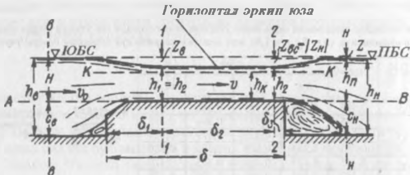
10.18-расм. Кенг остонали кумилган сув ўтказгич. Z_{\theta} — тикланаётган тушиш
