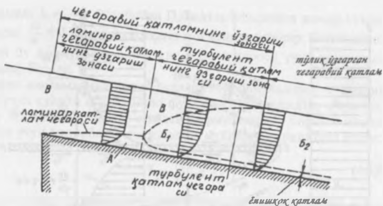
4.20-рasm. Канал бошида девор яқинидаги чегаравий қатламнинг ўзгариши
