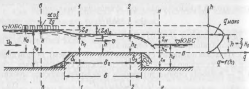
10.16-расм. Кенг остонали кўмилмаган сув ўтказгич
