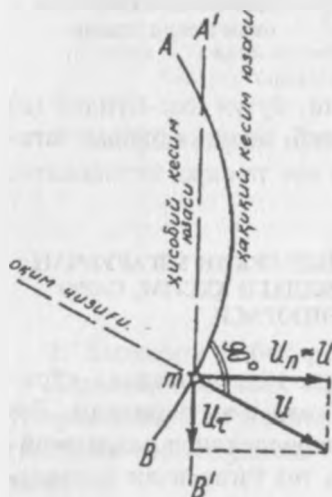
3.13-расм. AB кесимни текис ҳисобий кесим A'-B' билан алмаштириш
