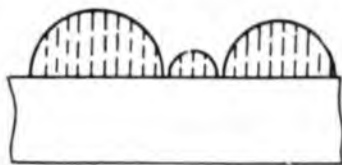
Рис. 6.7. Капельная конденсация на вертикальной стенке
