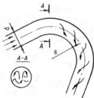
Рис. 5.15. Течение в изогнутой трубе
