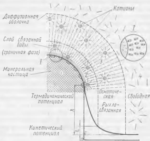
Рис. 1.3. Схема электромолекулярного взаимодействия поверхности минеральной частицы I с водой:
