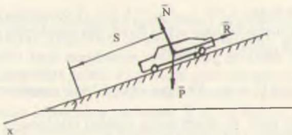
Avtomobilga qo'yilgan kuchlarning teng ta'sir etuvchisining A ishi, tashkil etuvchi kuchlar ishlarining algebraik yig'indisiga teng. Og'irlik kuchining ishi  $A(P)=P\cdot h=mgL\cdot \sin\alpha$ ,  $\bar{N}$  normal reaksiyaning ishi  $A(N)=0$  ga teng, chunki u avtomobilning harakat yo'nalişiga perpendikulyar; tormozlash  $\bar{R}$  kuchning ishi:
