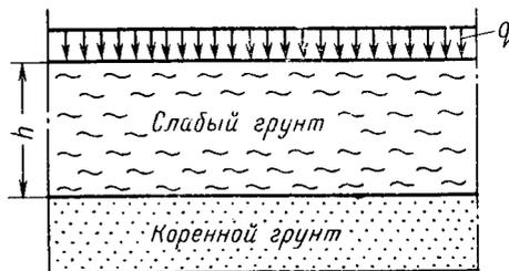
Рис. 4.11. Расчетная схема одномерной задачи уплотнения грунта
