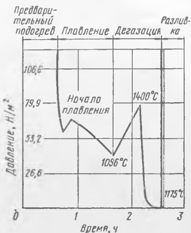
Рис. 94. Диаграмма рабочего цикла вакуумной плавки
