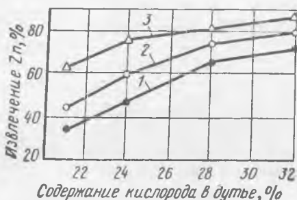
Рис. 70. Влияние обогащения дутья кислородом на извлечение цинка при фьюминговании шлака природным газом с холодным (1) и нагретым (2) воздухом, вдуваемым в ванну через фурмы при до- бавке угля и с холодным воздухом при сжигании газо-кислородо-воздушной смеси в топке с добавкой угля на ванну (3)
