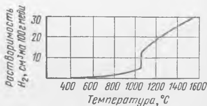
Рис. 81. Изменение растворимости водорода в меди в зависимости от температуры
