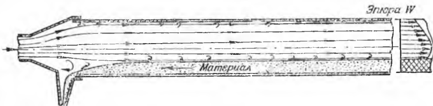
Рис. 44. Картина движения газов в барабанных вращающихся печах без внутренних теплообменных устройств
