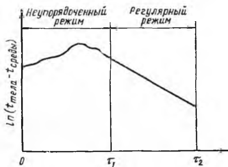
Рис. 81. Охлаждение тела при неупорядоченном и регулярном режиме
