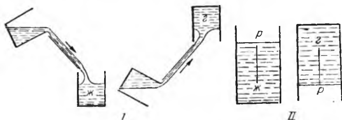
Рис. 26. Аналогия и различие в поведении жидкости и печного газа:
