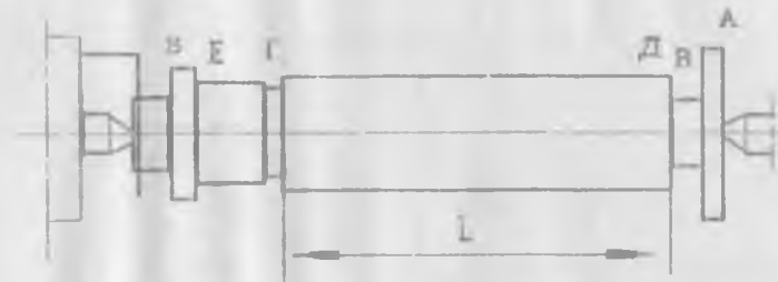
62-шакл. Деталнинг конуслиги бўйича ўлчамли ейилишини аниқлаш схемаси
