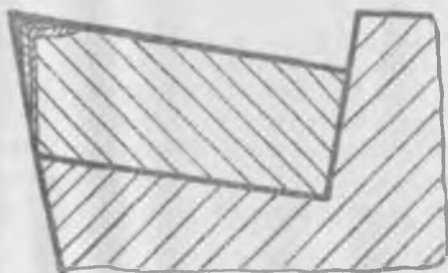
57-шакл. Қаттиқ қотишмали кескичларнинг ёйилиш схемаси
