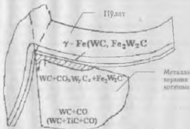
53-шакл. Кесувчи асбоб ва иншўв бериладиган материал қатламларида диффузиянинг содир бўлиши.
