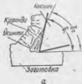
204- расм. а—кескичда ҳосил бўладиган ўсимта: \delta_1 —ўсимтанинг ҳосил бўлишига қадар кескичнинг кесиш бурчаги; \delta_2 —ўсимта ҳосил бўлгандан кейин кескичнинг кесиш бурчаги; б—кескичда таъсир этувчи кучлар.
