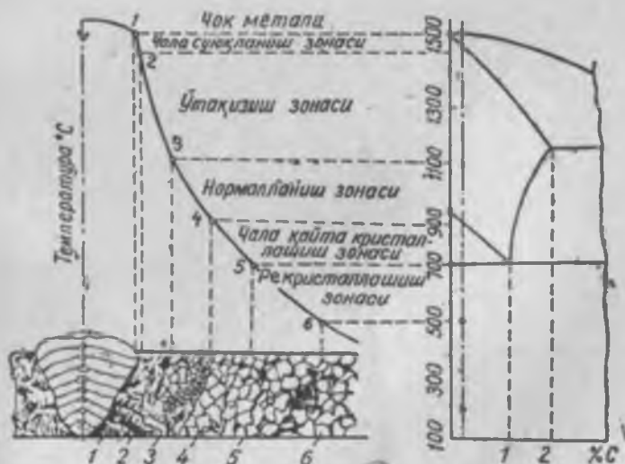
160-расм. Кам углеродли пўлатларни ёй ёрдамида дастаки усулда пайвандлашда иссиқлик таъсир этадиган зонанинг структуравий ўзгариши.
