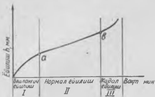
218-расм. Кескичнинг ейилиш характерининг схемаси.
