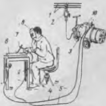
157-расм. Бир постли пайвандлаш ўзгартиргичи ёрдамида ўзгармас токда дастаки пайвандлаш:
