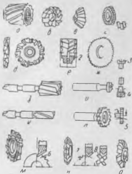
264- расм. Фрезаларнинг асосий турлари:
