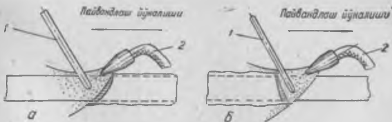
182- рас. Газвий пайвандлаш усуллари: а — чапга пайвандлаш; б — ўннга пайвандлаш:
