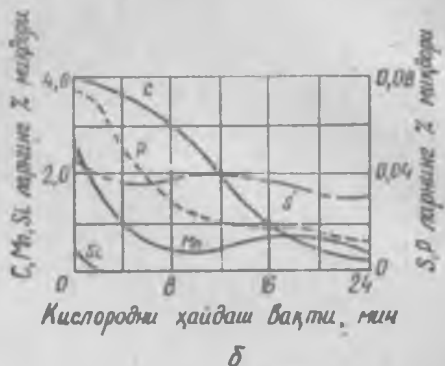
7 б-расм. Конверторга кислород ҳайдашда металл таркибининг ўзгариш графиги.
