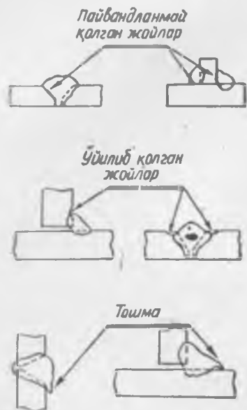
188-расм. Пайванд чок нуқсонлари схемаси.
