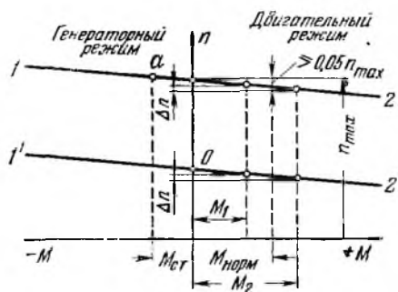
Рис. 219. Механические характеристики привода с двигателем постоянного тока
