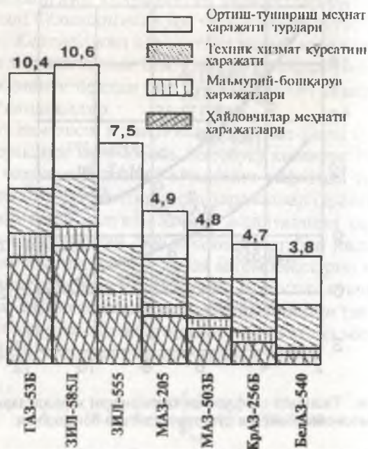
5 - расм. Автомобилларда ташишга (ткм) тўғри келувчи меҳнат харажатлари (киши-соат).
