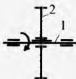
Shlitsali o'q bilan shlitsali bog'langan silindrsimon shesterniya. 1-shlitsali o'q; 2-shlitsali shesterniya.
