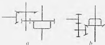
8.4-rasm. Qo'shaloq markaziy uzatmaning sxemasi
