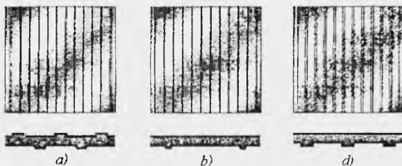
3.3-rasm. Qo'rg'oshinli startyor batareyalarning separatorlari: a – miporli; b – miplastli; v – polietilenli.
