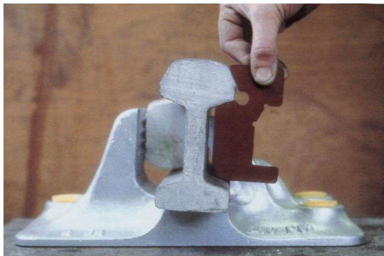
6.1-rasm. Rels seksiyasining tosh tagligi va yon qismining edirilish datchigi.
