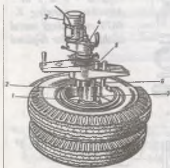
21-rasm. Tormoz barabanlarini silliglovchi va tormoz kolodkasining ishdan chiqqan qoplamalarini qirquvchi qo'zg'aluvchan moslama:
