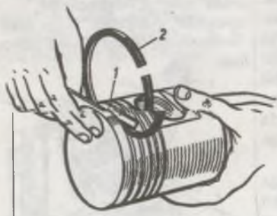
57-rasm. Porshen halqasi va ariqchasi orasidagi tirqishni tekshirish shakli
