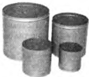
2.8-rasm. Chaqiqtoşning to'kma zichligini aniqlash uchun o'lchov silindrlari
