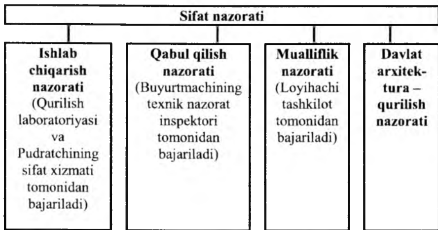
5.1-rasm. Qurilish – montaj ishlarining sifatini nazorat qilish tizimining tashkil etuvchilari
