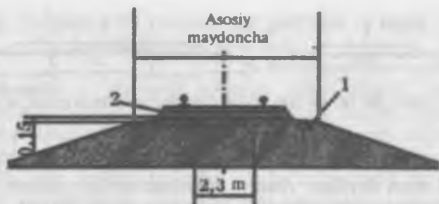
5.3-rasm. Yer polotnosining ikki yo'llik tuzilishi.
