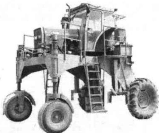
Рис.1.21. Высококлиренсный трактор Grape Harvest
