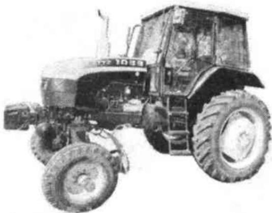
Рис.2.23. Общий вид универсально-пропашного трактора с регулируемым клиренсом в высоклиренсном положении
