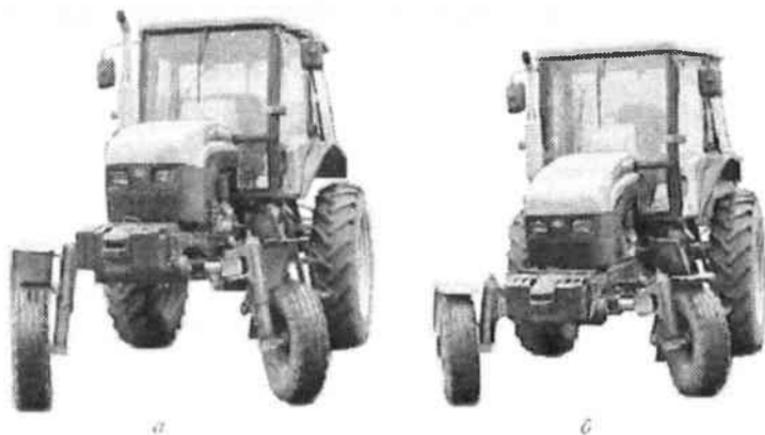
Рис.2.25. Общие виды универсально-пропашного трактора с регулируемым клиренсом в высококлиренсном (а) и низкоклиренсном (б) положениях
