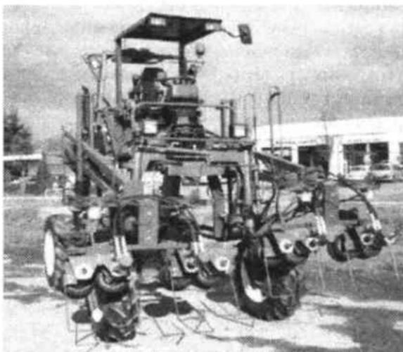
Рис.1.22. Высококлиренсное энергетическое средство компании Tracteurs Enjambeurs «FREMA»
