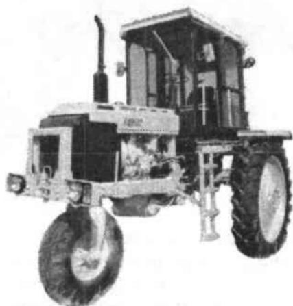
Рис.1.10. Универсально-пропашной трактор ТТ3-100К11
