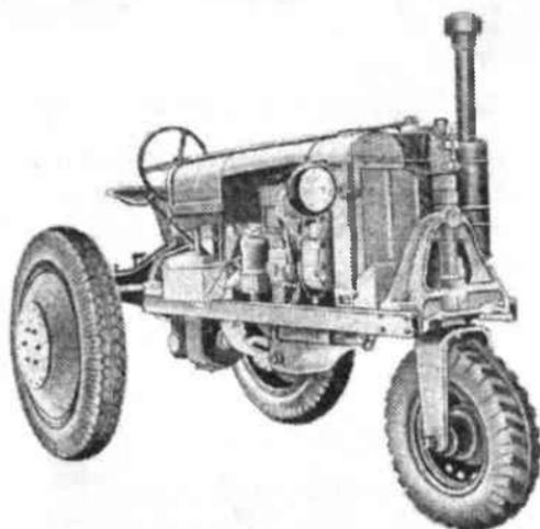
Рис.1.2. Универсально-пропашной трактор «Универсал-4» с колесами на пневматической шине
