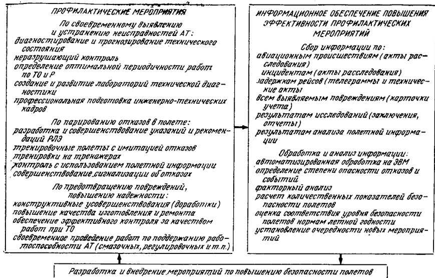
Рис. 36.2. Комплексная система обеспечения безопасности полетов при технической эксплуатации ЛА
