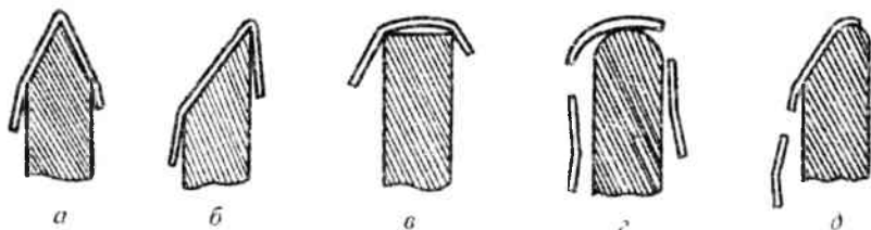
Рис.3.3. Формы лобовой поверхности стоек пассивных рабочих органов: а – клинообразно-симметричный; б – клинообразно-асимметричный; в – прямоугольный; г – полукруглый; д – комбинированный
