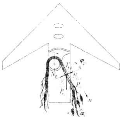
Рис.3.11. Схема, поясняющая условия скольжения растительных остатков по поверхности стойки
