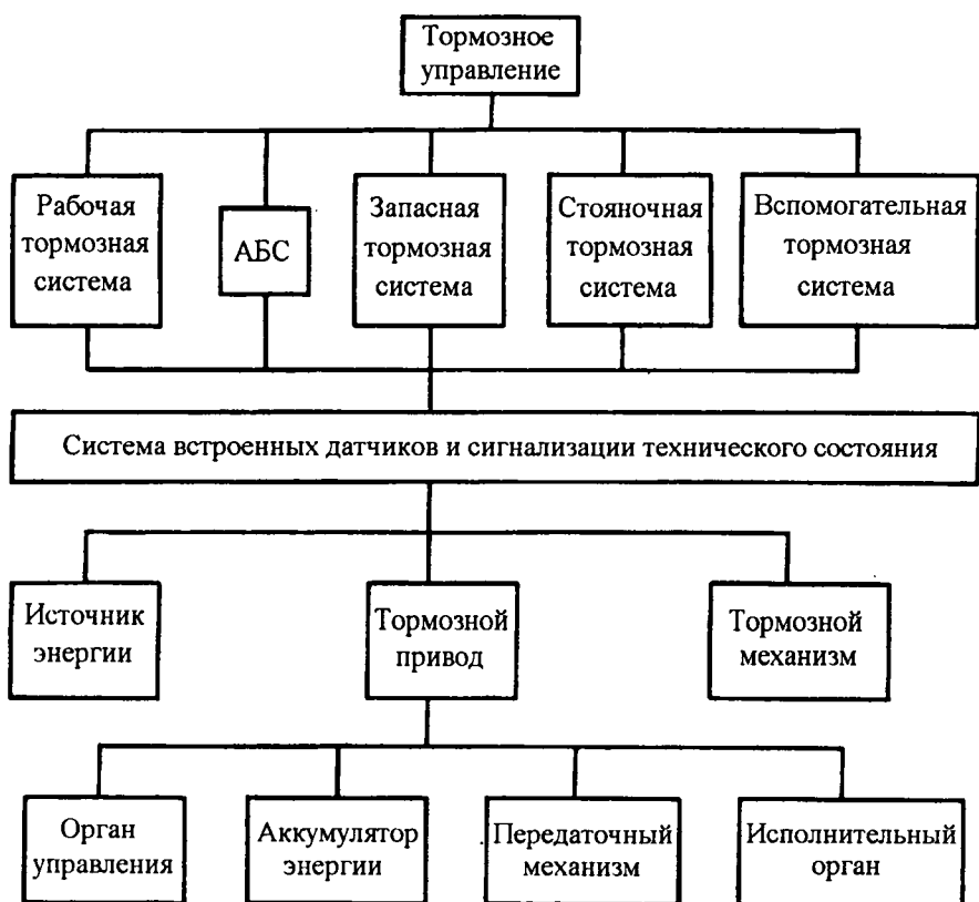
Рис. 11.2. Структурная схема тормозного управления
