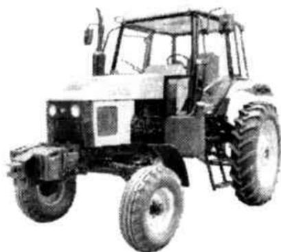
Рис.7.4. Макетный образец четырехколесного высококлиренсного универсально-пропашного трактора ТТ3-1030
