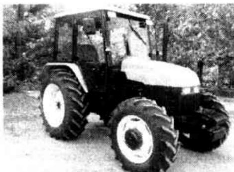
Рис.7.6. Макетный образец полноприводного универсально-пропашного трактора с передним ведущим мостом
