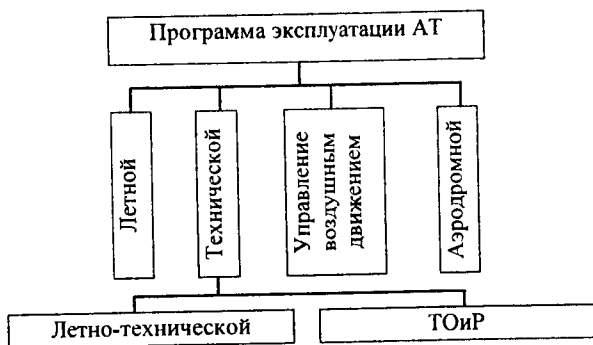
Рис. 9.1. Структура программы эксплуатации АТ
