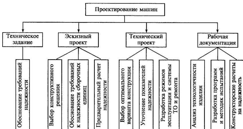
Рис. 7.1. Структурная схема процесса проектирования машины
