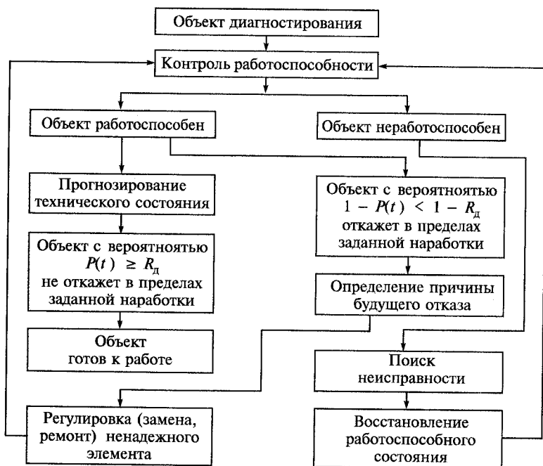
Рис. 8.8. Схема технического диагностирования: R_d — заданная вероятность безотказной работы
