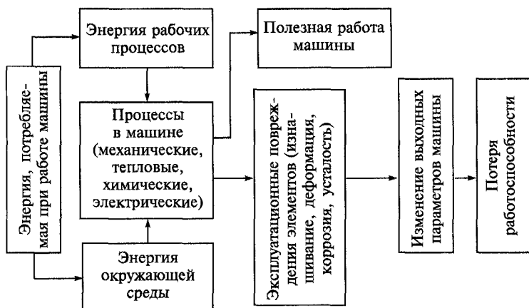
Рис. 2.1. Схема формирования процесса реализации машиной работоспособности
