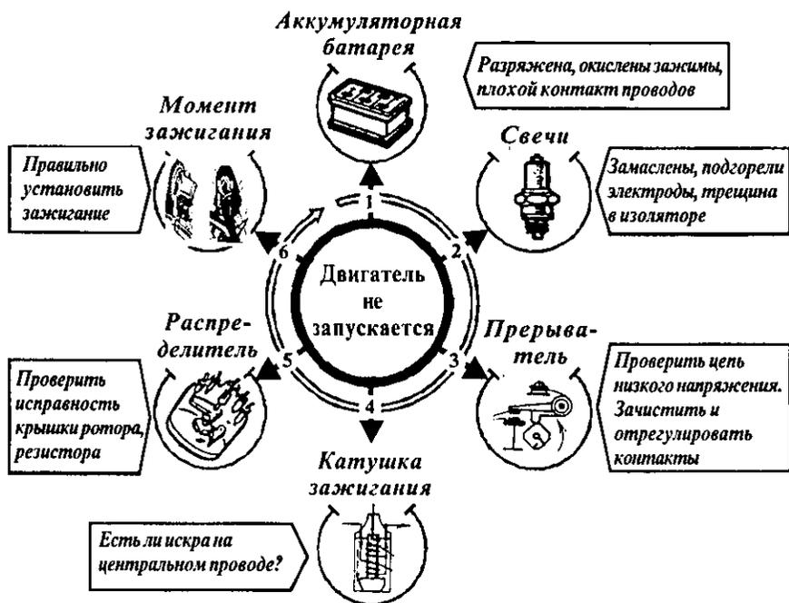
Рис. 46. Схема проверки системы зажигания
