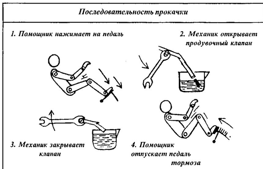
Рис. 48. Удаление воздуха из гидропривода тормоза колеса
