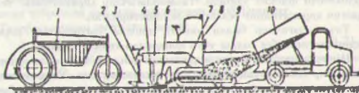
3.10-рәсм. Асфалт җәткәзгич технологик шун жаравинининг чизмәси: 1-моторли җалтак; 2-текислөвчи плита; 3-мувозанатловчи винт; 4-шнббалончи брус; 5-осма рамаси; 6-кориншманн таҗеимлаш учун шнек; 7-коринш қисми; 8-дигител; 9-бункер; 10-автосамосвал.
