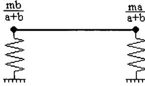
рис. 12.3 Динамическая схема фюзеляжа с независимыми колебаниями обеих подвесок.
