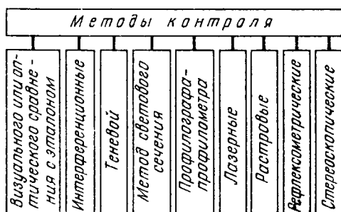
Рис. 2.2. Основные методы контроля шероховатости поверхности
