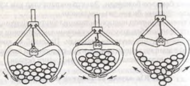
26-расм. Ёгоч ғулаларни кўтаришда қўлланиладиган қисқичлар.
