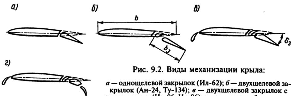
Рис. 9.2. Виды механизации крыла:
