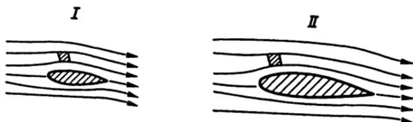
Рис. 3.8. Струйки и сходственные элементы в двух потоках, обтекающих геометрически подобные тела
