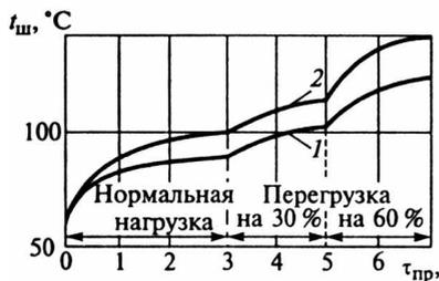
Рис. 11.7. Зависимость температуры деталей шины  $t_{ш}$  от времени пробега  $\tau_{пр}$  при различных нагрузках:
