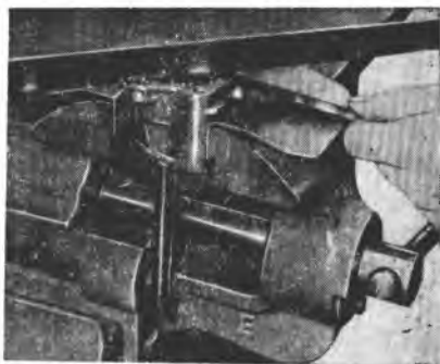
Рис. 4.20. Проверка осевого зазора в масляном насосе
