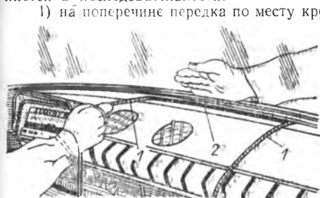
Рис. 3.67. Установка ветрового стекла: 1 — шнур для установки ветрового стекла; 2 — уплотнитель.
