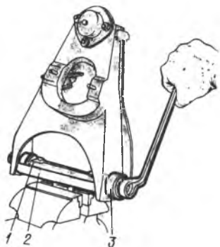
Рис. 4.32. Напрессовка шарниров нижнего рычага:
