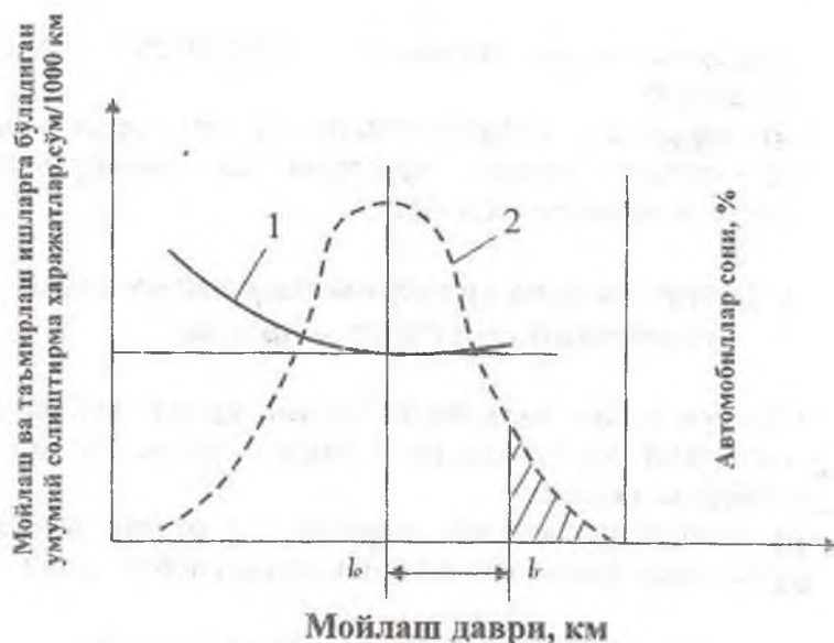
10-расм. Мойлаш ва таъмирлаш ишларига бўладиган солиштирма харажатларнинг мойлаш даврига боғлиқлик схемаси.
