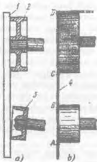
1.7.2- rasm. Shkivlarning to'g'ri o'rnatilganligini tekshirish.
