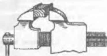
1.2.25-rasm. Gira (tiski) da detalni mahkamlash
