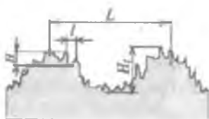
2.27-rasm. Sirt g'adir-budirlik va to'liqsimonligi.
