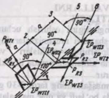
14.10-rasm. Olti silindrli V-simon dvigatelni muvozanatlash (krivoshiplari orasidagi burchak 120°)
