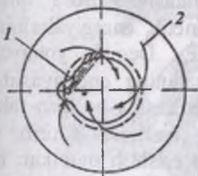
9.5-rasm. Pardali aralashma hosil qilinadigan kamera:
