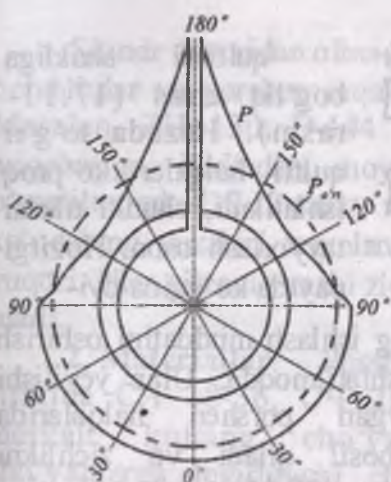
17.9-rasm. Porshen halqalarining bosimlar epyurasi
