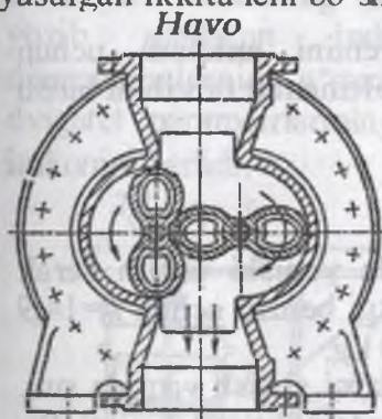
10.3-rasm. Havoning hajmiy sarfini o'lchovchi asbob sxemasi
