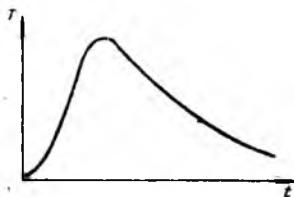
1.2-rasm. Jismning istalgan nuqtasida vaqt bo'yicha harorat o'zgarishining grafik tasviri
