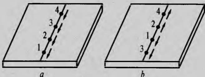
7.15-rasm. Listlarni payvandlashda uzun choklarni solish tartibi: a – qirradan boshlab teskari pog'onali payvandlash; b – o'rtasidan boshlab pog'onali payvandlash; 1...4 – chok uchastkalarini solish tartibi.
