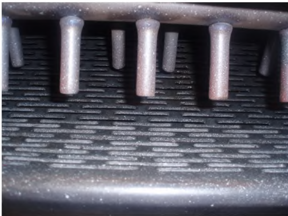
8.7-rasm. Tozalagichning asosiy ishchi qismlari, ta'minlagich va qoziqchali barabanning umumiy ko'rinishi
