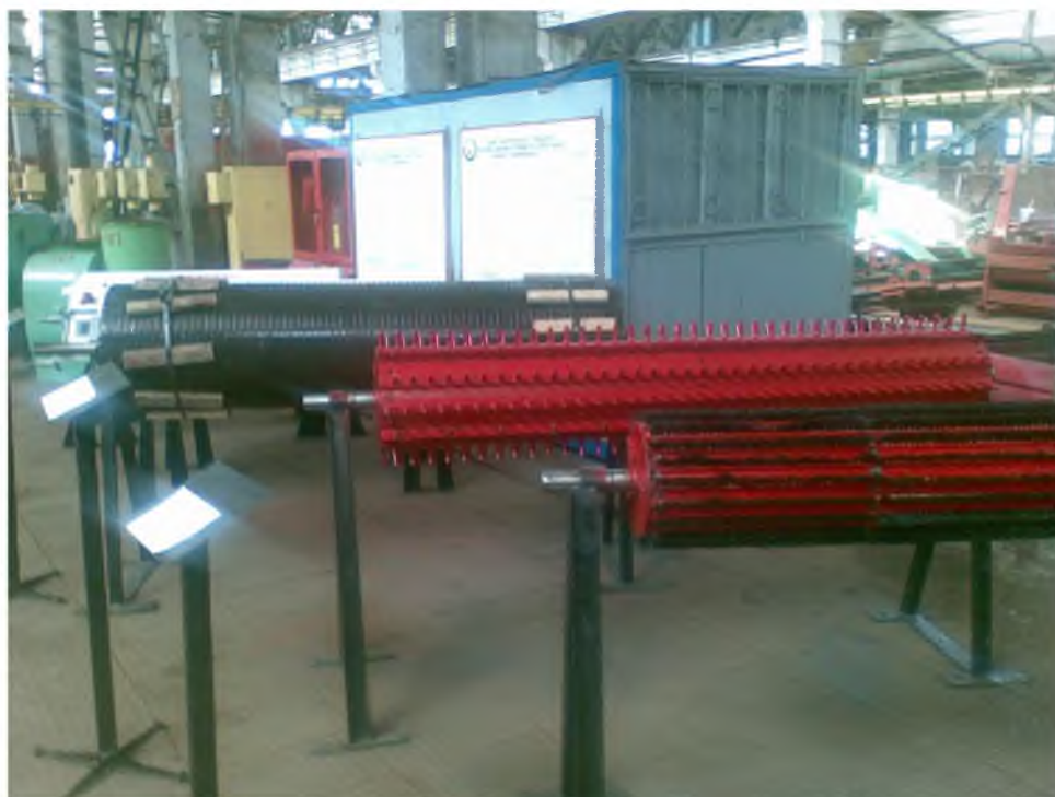
8.3-rasm. Tozalagichlarning asosiy ishchi qismlari
