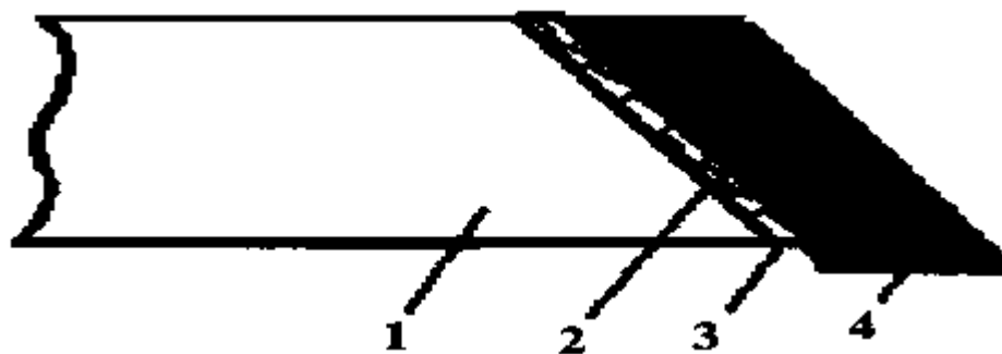
4.1.-rasm. Lemexga qo'yilma payvandlab ta'mirlash:
