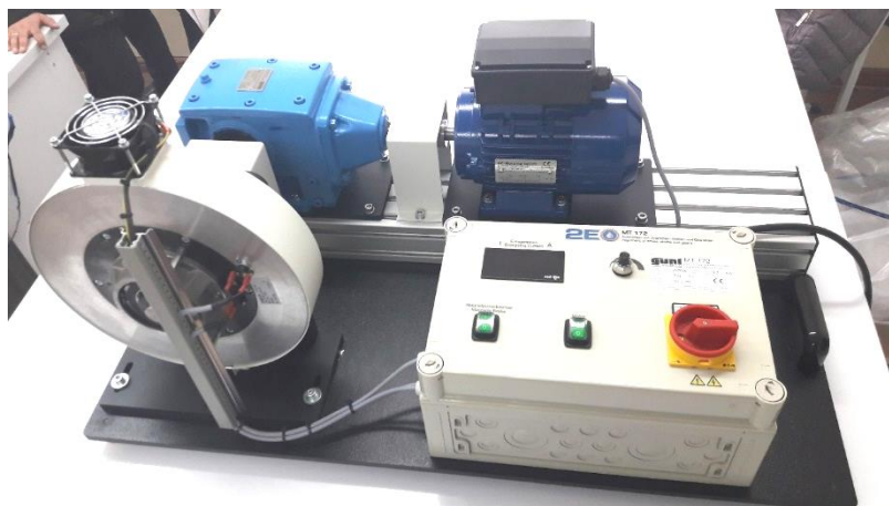
8.1-rasm. MT-172 rusumli reduktorlarni sinash stendi
