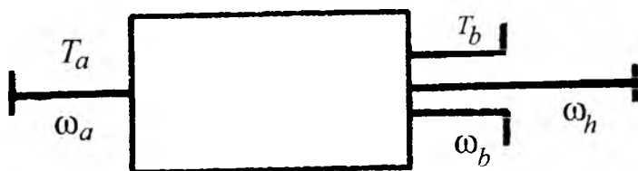
3.37-shakl. Planetar uzatmaning strukturaviy sxemasi.
